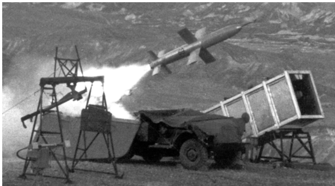
ניסוי ירי של הלוו. הטיל משוגר ממשגר יבשתי מבצעי כשמצידיו דגם פיתוח של המשגר הימי ו"משגר השער"
